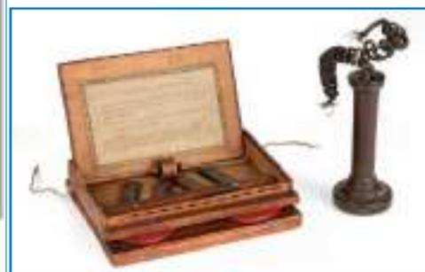
fig. 2 - Il primo detector magnetico
