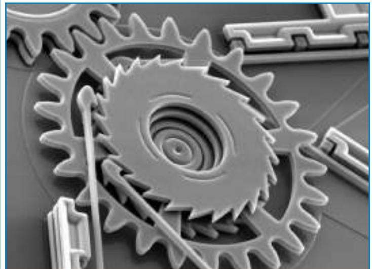
fig. 7 - Microstrutture realizzate con la tecnica del 'laser micromachining'
