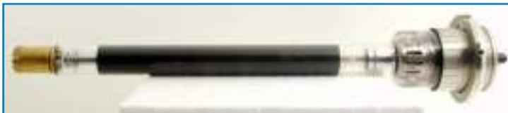
fig. 1 - Il TWT della RCA che equipaggiava il Telstar-1
