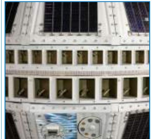
fig. 7 - Le cavità equatoriali a 4 e 6 GHz
