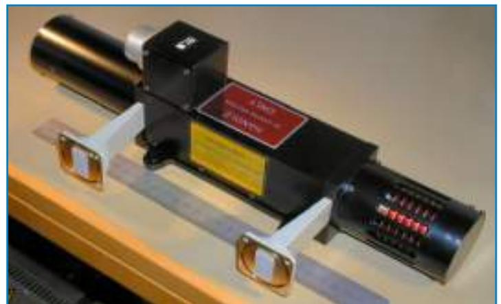
fig. 2 - Un TWTA compatto, comprendente il tubo, l'alimentatore, il magnete, il dissipatore e le flange d'attacco per le guide d'onda
