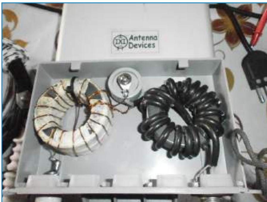
figura 12 - Trasformatore di impedenza e RF choke inseriti nello stesso contenitore a tenuta stagna
