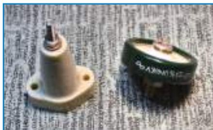
figura 7 - condensatore alto isolamento e isolatore passante
