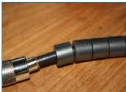
figura 13 - RF choke realizzato con ferriti sul coax RG-213
